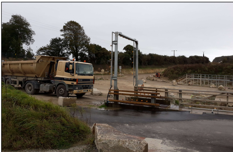
Photo n°6: Vue sur le portique de lavage des camions en sortie de carrière
